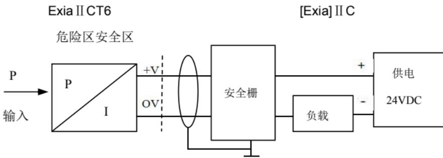
图 6 二线制 4mA~20mADC 输出本安系统图
