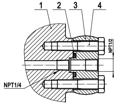
1/2NPT 不锈钢椭圆形法兰 (代码 1)
