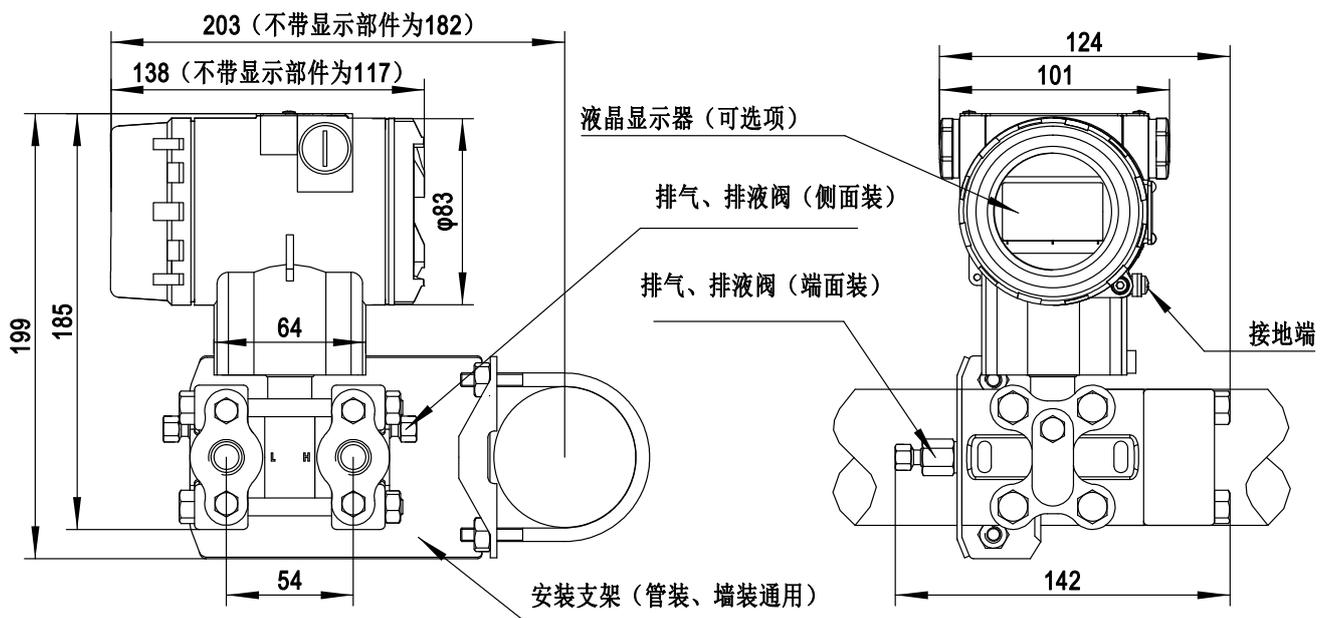
水平配管连接方式 (侧面)
