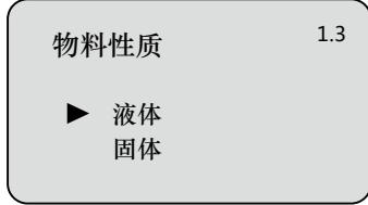
可用 **OK** 键移动箭头，选择物料性质为液体或固体；按 **OK** 键确认，进入物位变化速度设置菜单。液晶显示
