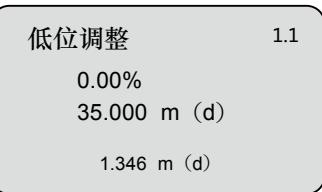
按 **OK** 键，进入编程低位百分比，参见前述参数编辑方法中的字符/数字参数编程方法，编辑百分比值及距离值。编辑完成后，按 **OK** 键确认，按 **BK** 键放弃编程。
