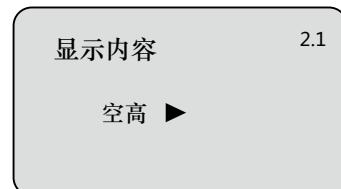
表示当前显示内容的参数是空高，即仪表显示测量的空高值。按
