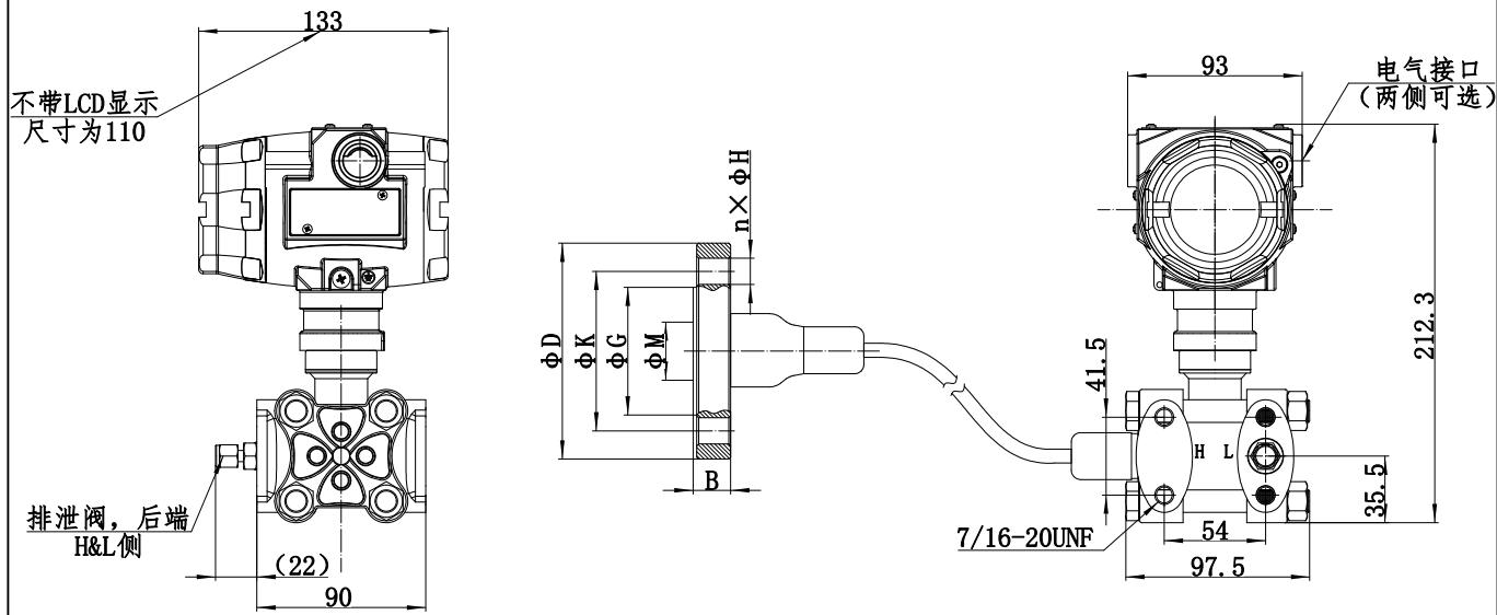
远传法兰带插入筒整机尺寸图
