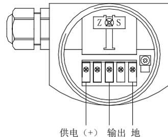
注: 接线端子“地”接电缆的屏蔽线, 屏蔽要可靠接地; 或将“地”接在壳体的端子上。
