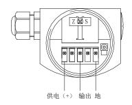
注:接线端子"地"接电缆的屏蔽线,屏蔽要可靠接地;或将"地"接在壳体的端子上。
